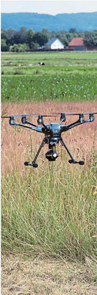
Die Drohne verfügt über eine Wärmebildkamera, durch die sich die Rehkitze orten lassen.
